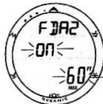
Рис. 133 Установка сигнала 2 глубины свободного погружения
