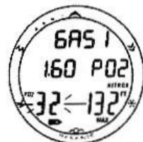
Рис. 43 Установка FO2 GAS 1 (установлено 32% O2)
