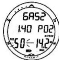
Рис. 44 Установка FO2 GAS2 (50% O2)
