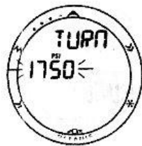
Рис. 53 Установка включения давления
