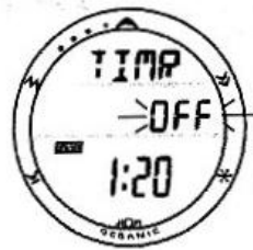
Рис. 130 Установка таймера завершена.
