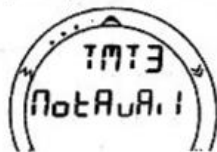
Рис.6В Статус батареи в трансмиттере 3 - Недоступен.
