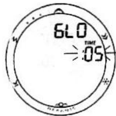
Рис. 61 Установка длительности подсветки
