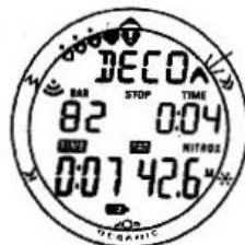
Рис. 92А Вход в декомпрессию в метрической системе единиц (когда сработал сигнал)
