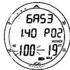
Рис. 45 Установка FO2 GAS3 (100% O2)
