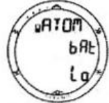
Рис. 37 Статус батареи низкий
