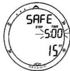
Рис. 59 Установка остановки безопасности
