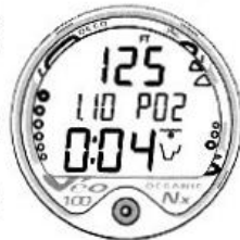
Рис 33 Основной дисплей №4 бездекомпрессионного погружения
