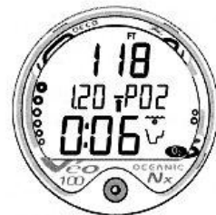
Рис. 47 Высокое PO2 предупреждение
