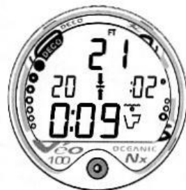
Рис. 37 Основной дисплей декомпрессии
