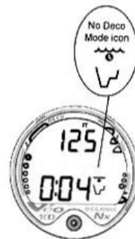
Рис. 30 Основной дисплей №1 бездекомпрессионного погружения
