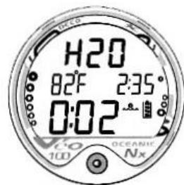
Рис. 16 Поверхностный режим (компьютер мокрый)
