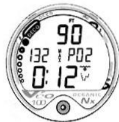
Рис. 54 Установка предела декомпрессии
