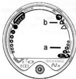
Рис. 2а Индикатор накопления кислорода и скорости всплытия
