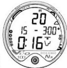
Рис 34 Остановка безопасности бездекомпрессионного режима
