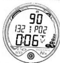
Рис. 27 Установка контроля кислорода
