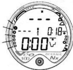
Рис. 44 Дисплей состояние нарушения №3
