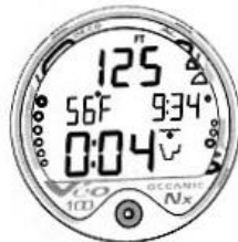
Рис 32 Основной дисплей №3 Бездекомпрессионного погружения
