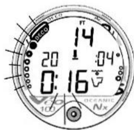
Рис. 42 Дисплей состояние нарушения №1
