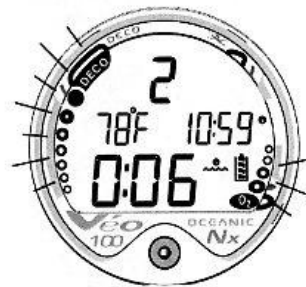
Рис. 46 Режим измерителя на поверхности
