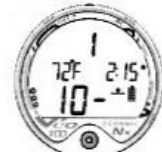
Рис. 59 Поверхностный режим (более 9:59)
