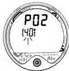
Рис. 24 Установка сигнала PO2
