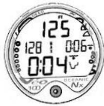
Рис 31 Основной дисплей №2 бездекомпрессионного погружения
