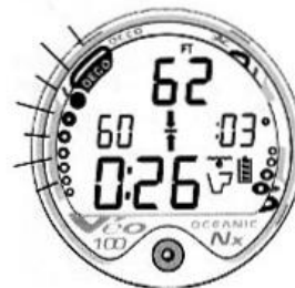
Рис. 43 Дисплей состояние нарушения №2
