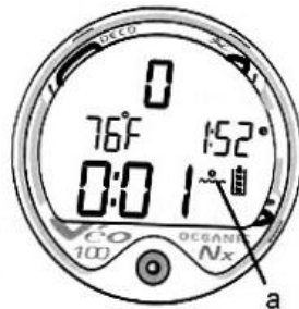
Рис. 15 Поверхностный режим (компьютер сухой)
