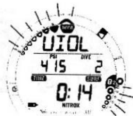
Рис. 84 Дисплей поверхностного режима измерителя при нарушениях
