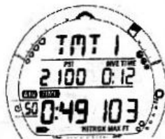
Рис. 71 Альтернативный дисплей 2 нормального погружения без декомпрессии
