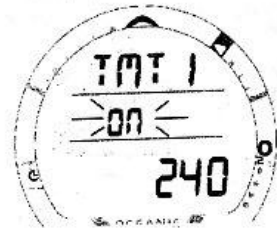
Рис. 42 Установка Трансммитера 1 TMT 1
