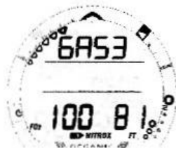
Рис. 92 Экран переключения смеси GAS 3
