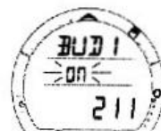
Использование TMT 2 для проверки давления BUD1
