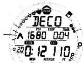
Рис. 74 Вход в декомпрессию
