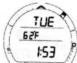
Рис. 70 Альтернативный дисплей 1 нормального погружения без декомпрессии
