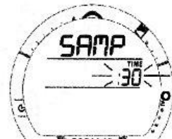
Рис. 41 Установка частоты дискретизации
