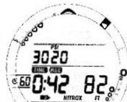
Рис. 91 Нормальный режим погружений (после переключения на GAS 2)
