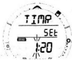
Рис. 108 Установка таймера свободного погружения
