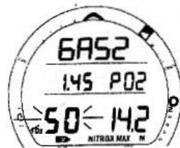
Рис. 23 Установка FO2 для смеси 2 (50% O2)
