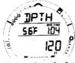
Рис. 119 Основной дисплей свободного погружения при сигнале глубины
