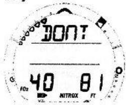
Рис. 87 Сигнал давление в баллоне не включено
