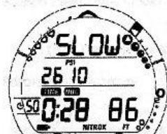
Рис. 67 Сигнал скорости всплытия
