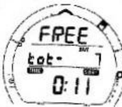
Свободный режим Рис. 1. Рабочие режимы
