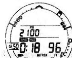
Рис. 69 Режим нормального погружения без декомпрессии
