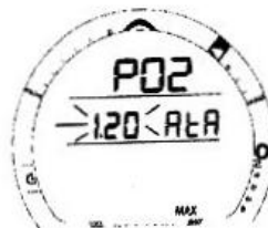
Рис. 34 Установка сигнала "высокое парциальное давление кислорода" (PO2 ALARM)
