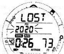
Рис. 61 Потеря связи под водой
