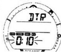
Рис. 31 Установка звукового сигнала оставшегося времени погружения
