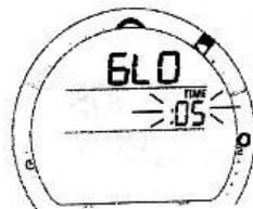
Рис. 40 Установка длительности подсветки
