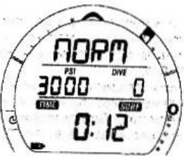
Рис. 17 Нормальный поверхностный (после погружения, VT3 сухой)
