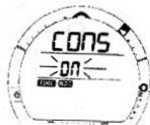
Рис. 39 Установка «консервативного фактора»
