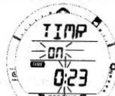
Рис. 117 Дисплей статуса CDT (статуса таймера) свободного погружения включен
