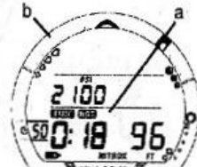
Рис. 63 Оставшееся время погружения без декомпрессии
