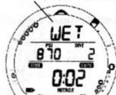
Рис. 68 Нормальный поверхностный режим (устройство мокрое)
