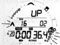
Рис. 86 Высокое содержание кислорода (главный дисплей)
