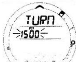
Рис. 32 Установка сигнала "Давление включено"
