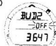
Использование TMT 3 для проверки давления BUD2
