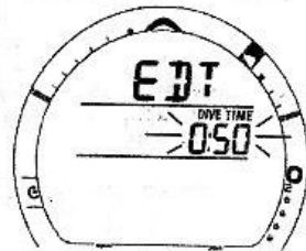
Рис. 29 Установка сигнала EDT
